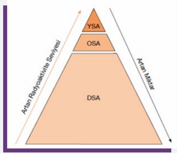
Şekil 5. Düşük, orta ve yüksek seviyeli atıklar ve radyoaktivite seviyeleri (Bulucu, 2018)
