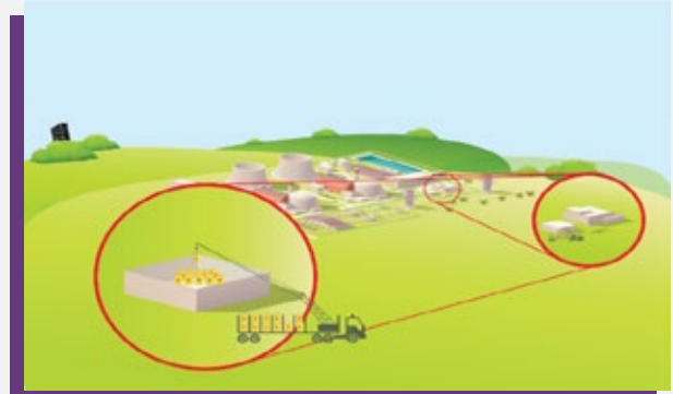
Şekil 6. Düşük seviyeli radyoaktif atıklar için yüzey depolama tesisi (ETKB, 2015)
